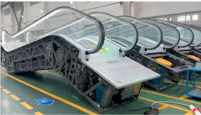
図5: 滝本館の工場生産における4台のEME
